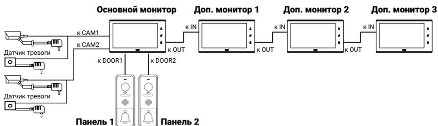
Вызывные панели подключаются только к основному монитору.
