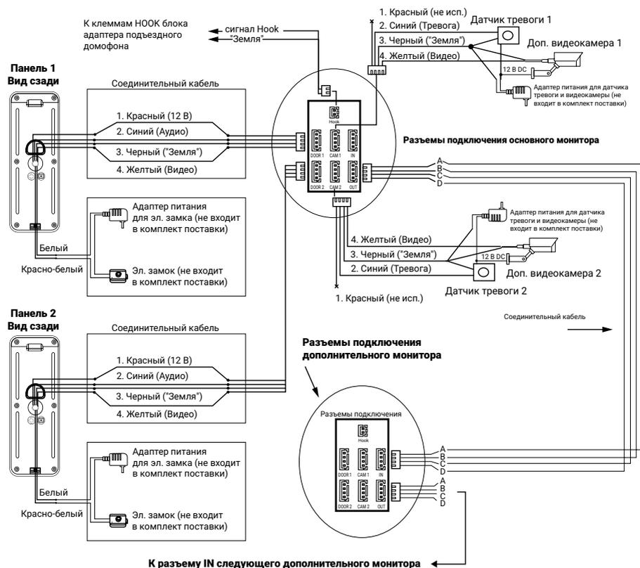
В экранном меню основного монитора должен быть включен режим «Основной», а в дополнительных – режим «Дополнительный» (см. «ВИДЕОДОМОФОН CTV-DP4105AHD. ИНСТРУКЦИЯ ПО ЭКСПЛУАТАЦИИ», раздел «Экранное меню. Настройки монитора»).
