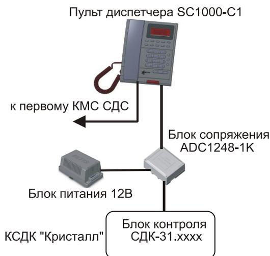
Рис.20 Структурная схема подключения СОС к КСДК «Кристалл»
