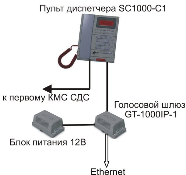
Рис.21 Структурная схема СОС с использованием ГШ GT-1000IP-1
