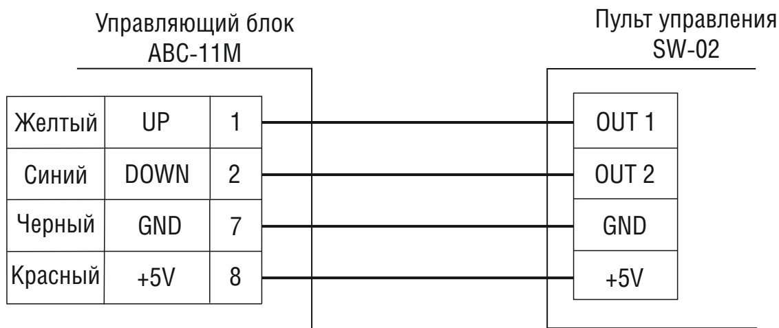
Рисунок 6.8.2 Схема подключения пульта дистанционного управления шлагбаумом «SW-02»
