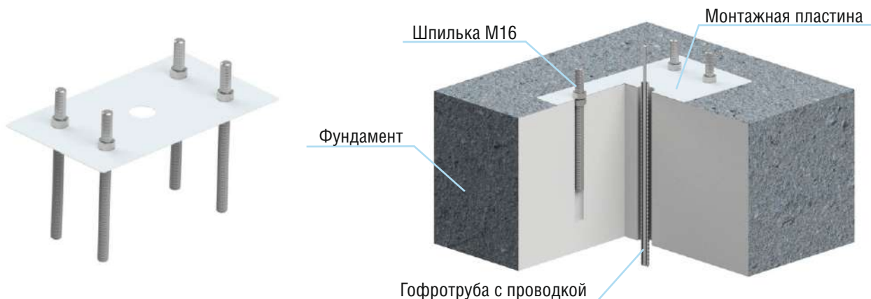
Рисунок 7.2.1 Устройство фундамента с монтажным комплектом
