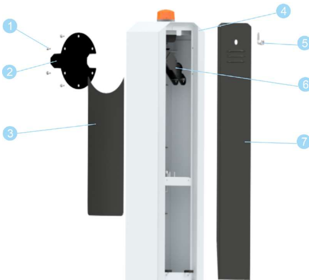
Рисунок 6.1.1 Внешний вид и состав корпуса шлагбаума
