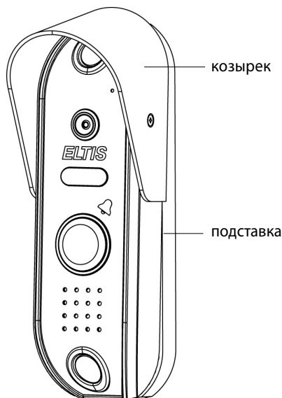
Рис.2 Внешний вид блока вызова с козырьком и подставкой
