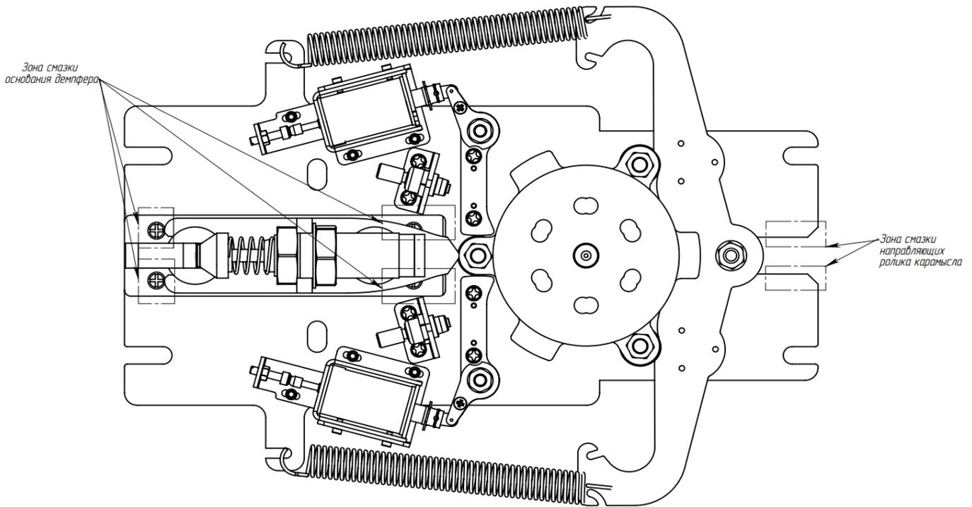
Рисунок 5 – Места смазки механизма изделия
