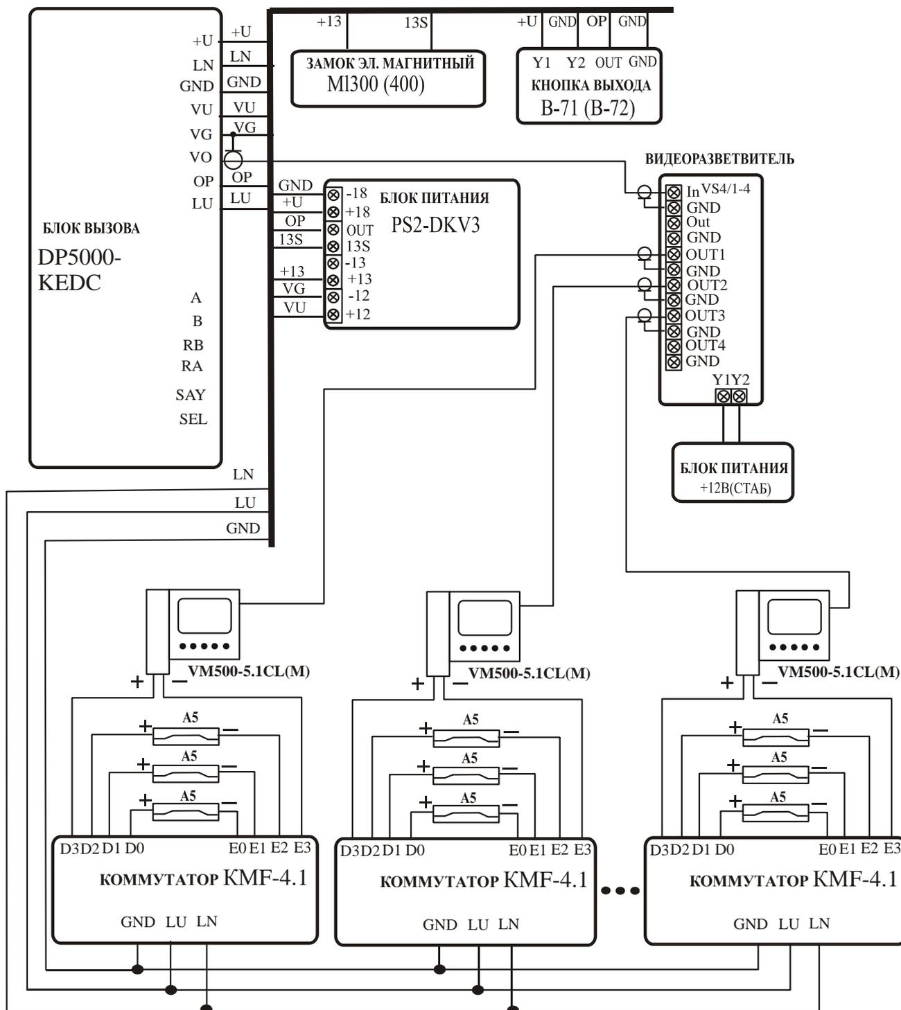
Рис.5 Пример схемы подключения DP5000.B2-KEDC в автономном режиме в составе домофонного комплекса с этажными коммутаторами
