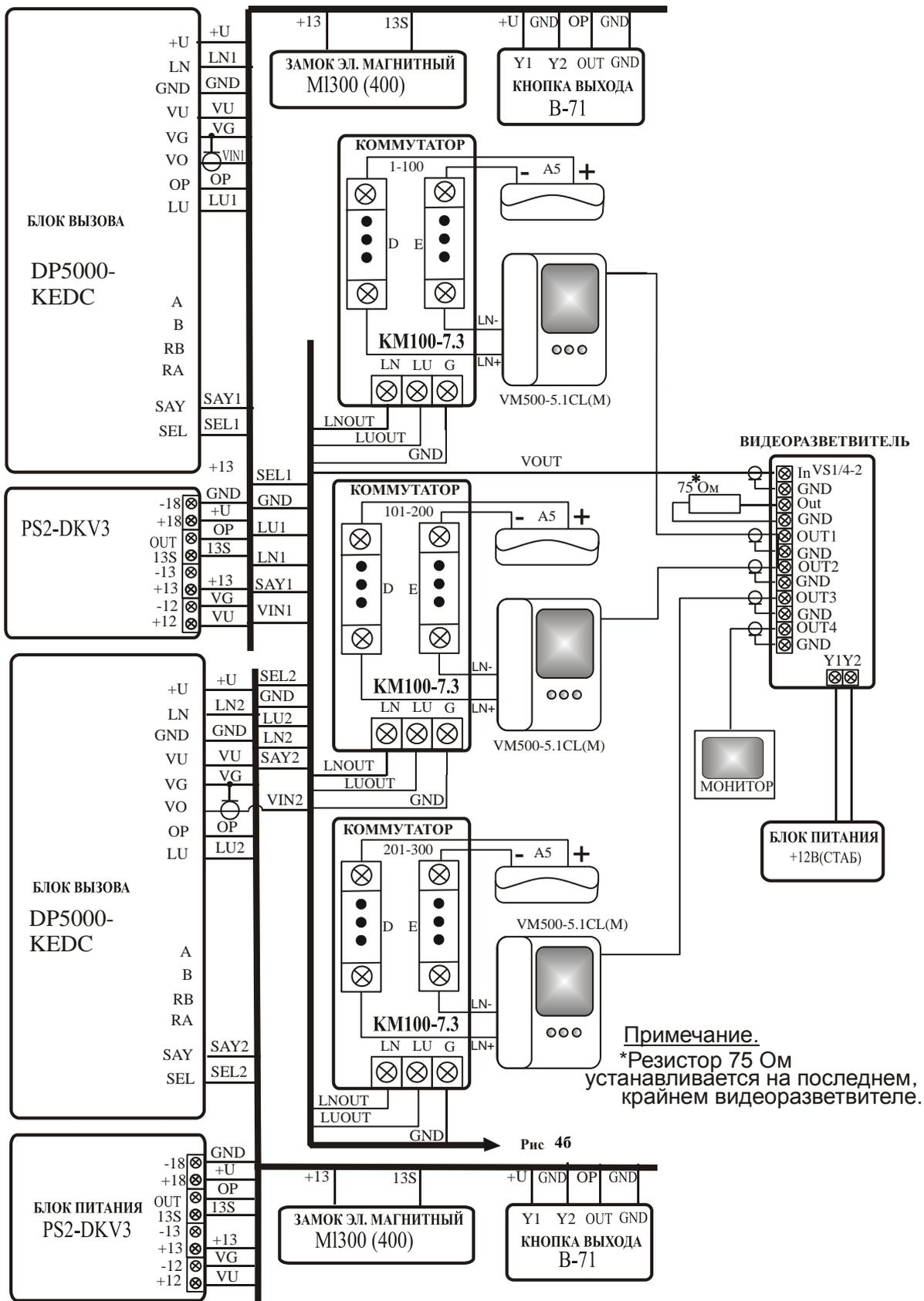
Рис.4а Пример схемы подключения DP5000.B2-KEDC в автономном режиме в составе домофонного комплекса (аналог ELTIS303).
