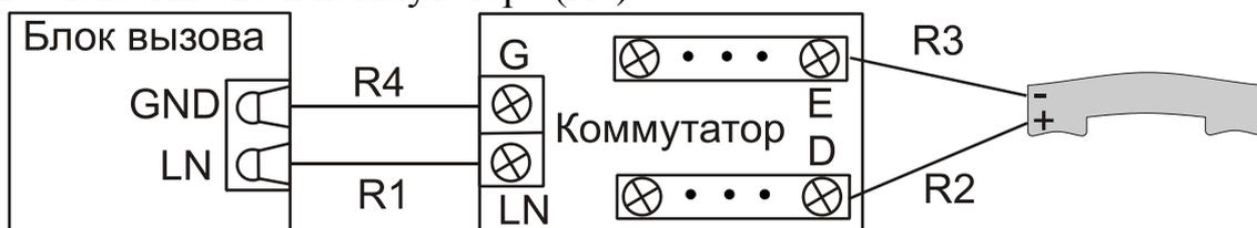
Сопротивление линии между клеммами LU блока вызова и коммутатора — не более 100 Ом.
