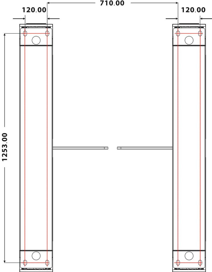
5. Отодвиньте турникет в сторону и просверлите отверстия в соответствии с разметкой.
