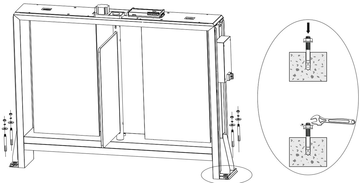
8. Подключите кабели и проведите тестовое включение. Если тест пройден успешно, установите боковые стойки и верхнюю крышку.
