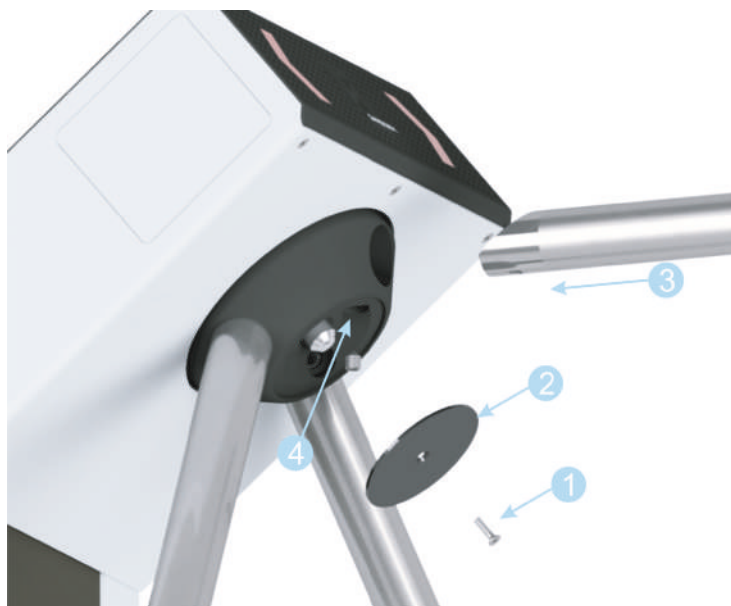
Рисунок 7.5.1 - Установка стандартной преграждающей планки
