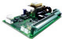
Электронная плата 624BLD (встроена в систему автоматики) См. стр. 152
