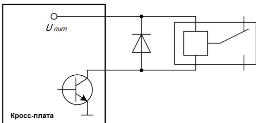
Рисунок 8 – Схема подключения диода параллельно обмотке реле
