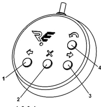
Рисунок 7 – Нумерация кнопок ПУ
