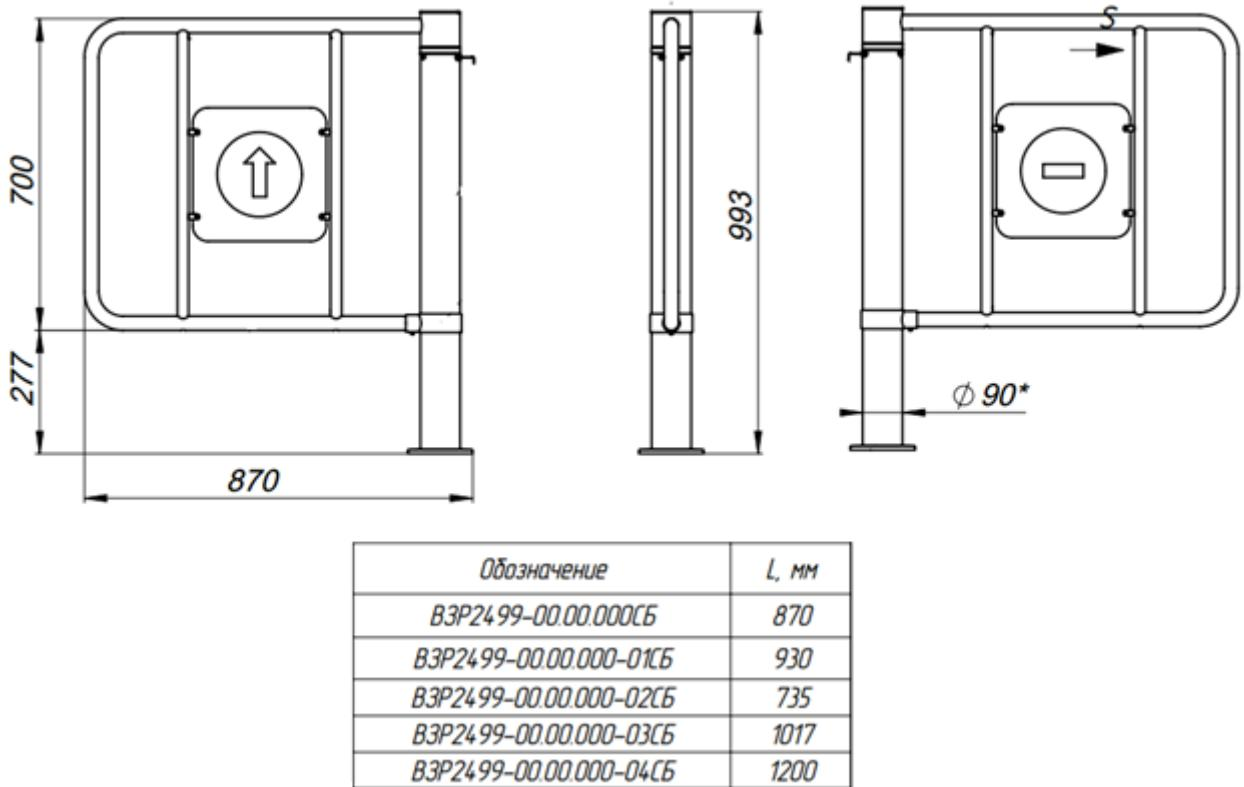
Рисунок 2 – Габаритные размеры калитки из нержавеющей трубы, со вставкой из нержавейки.
