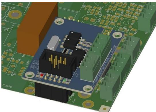
В плату шлагбаума «Цифра-1М» модуль подключается к разъему X15 и закрепляется на ней через дистанционные втулки винтами М3 (входят в комплект) через крепежные отверстия
