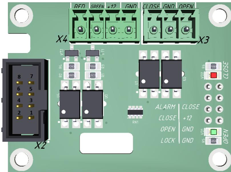
Для получения сигналов о положении шлагбаума (открыт / закрыт) стороннее оборудование подключается к разъему X3, сигнал считается положительным при закрывании на землю.
