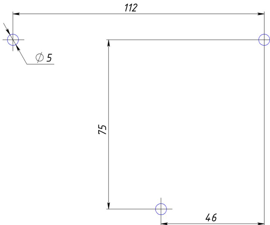
Шаблон-разметка для вертикальной установки видеомонитора
