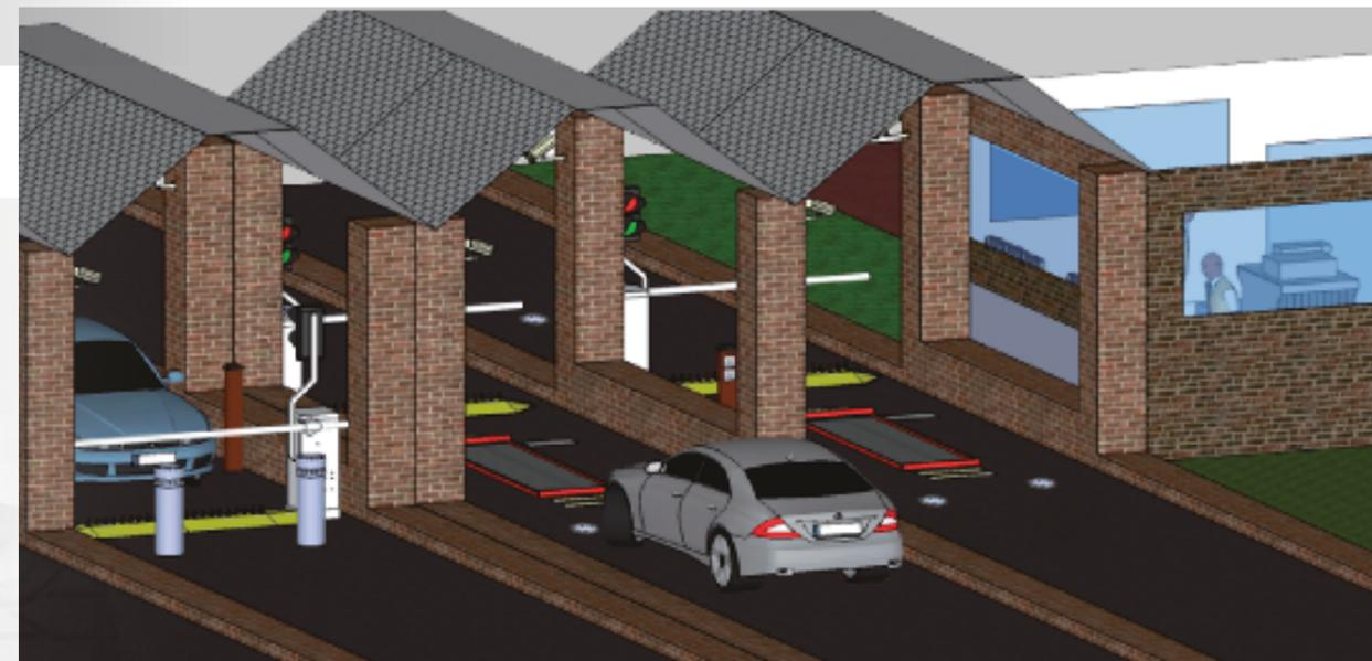
На въезде оборудован пункт досмотра с дорожными блокираторами, шлагбаумами и системой досмотра днища. Подъезжающий автомобиль останавливается перед зоной досмотра для пропуска в зону досмотра.
