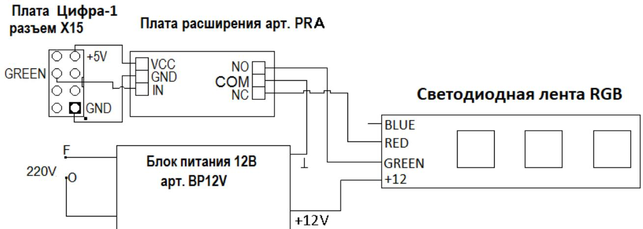
Блок питания рекомендуется устанавливать внутри блока электроники.
